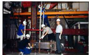
写真2：研究室でのリユース鋼材を用いた構造物の検証実験
